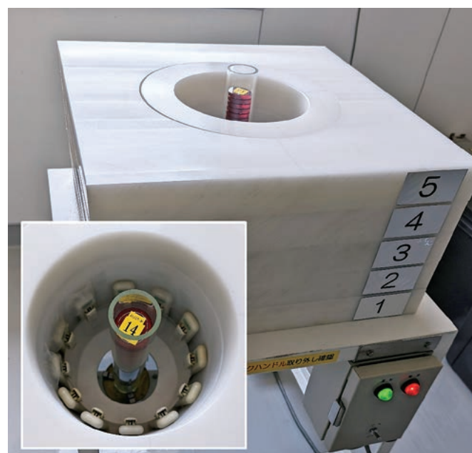
写真 1 簡易校正器。中心部分の線源ホルダーに ^{226}\text{Ra} を筒状に重ね、周りに等間隔に線量計を配置する。線源ホルダーはモーターで回転するようになっている。
