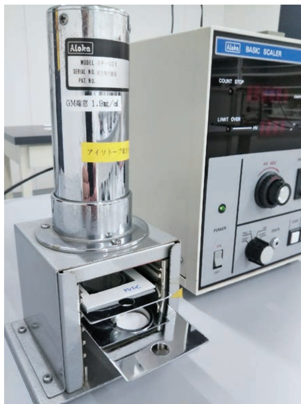
図1 測定のセットアップ。試料などを見やすくするために、プレートを引きだした状態で撮影している。
